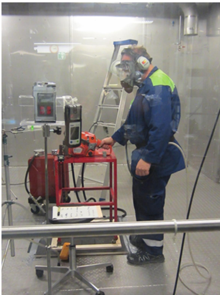
Kuva 10. Moottorisahatesti. Häkämittarit etualalla, takana hydraulinen pumppu ja öljysäiliö.
