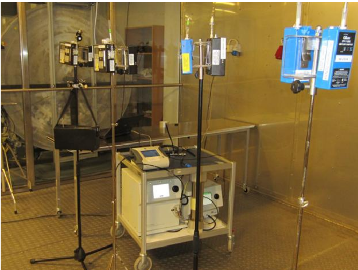
Kuva 9. Mittauskalustoa varsinaisten testien aikana. Erillisessä vaunussa SMPS- ja OPS-hiukkasmittarit.
